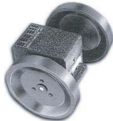
Это устройство посылает импульсный сигнал для измерений в 1 метр, 0.1 м, 1 см или 1 мм когда его колеса соприкасаются с движущимся материалом (таким как бумага, ткань, пластмассовая пленка ремень конвейера, лист металла и т. д.) или когда колеса соприкасаются с валом врачающимся синхронно с движущимся материалом. Линейные движения могут регистрироваться электрическим или электронным счетчиком использованным вместе с этим прибором.
