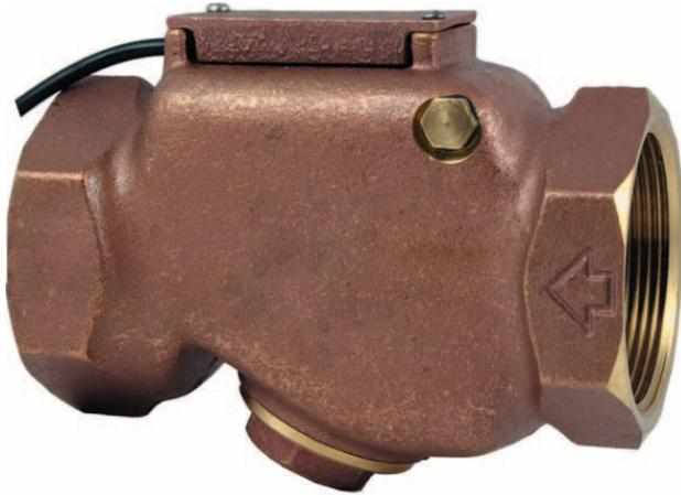
Датчики-реле потока лепестковые серии ДР-ПП предназначены для контроля потока воды через трубопровод, а также для управления исполнительными механизмами с целью защиты оборудования от «сухого хода». При наличии потока воды в трубопроводе датчик-реле подает сигнал на выходы.
