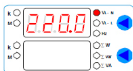
Рис. 19 – Пример работы прибора. Режим отображения среднего фазного напряжения
