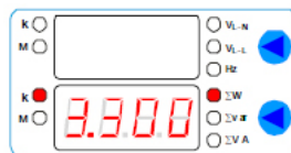
Рис. 20 – Пример работы прибора. Режим отображения суммарной активной мощности
