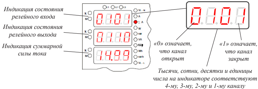
Рис. 17 – Пример работы прибора. Режим отображения суммарной силы тока. Суммарная сила тока равна 14,99А
