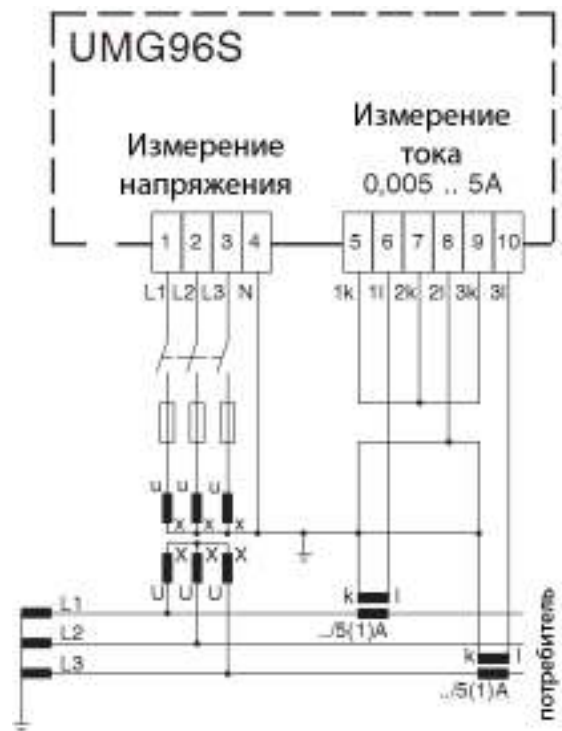
Схема: Пример подключения 6 3 трансформатора напряжения и 2 трансформатора тока.
