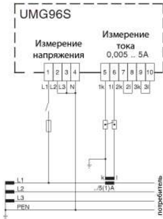
Схема: Пример подключения 5 Измерение по одной фазе.
