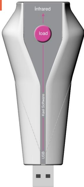
Реле времени астрономическое, разработанное компанией KAEL, может быть запрограммировано с помощью устройства CON-3.
