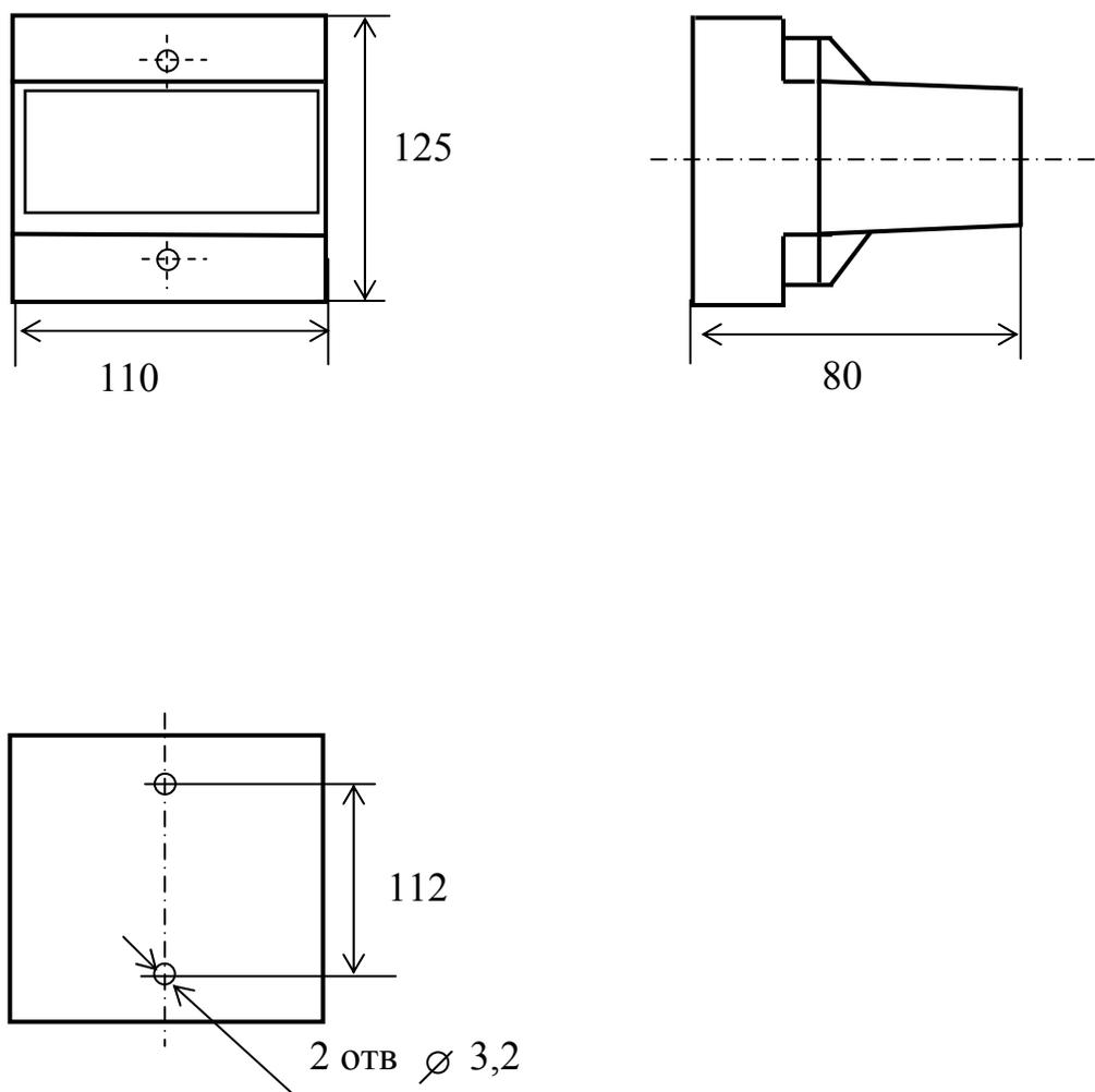
Рисунок А.1 – Габаритные и установочные размеры ИП
