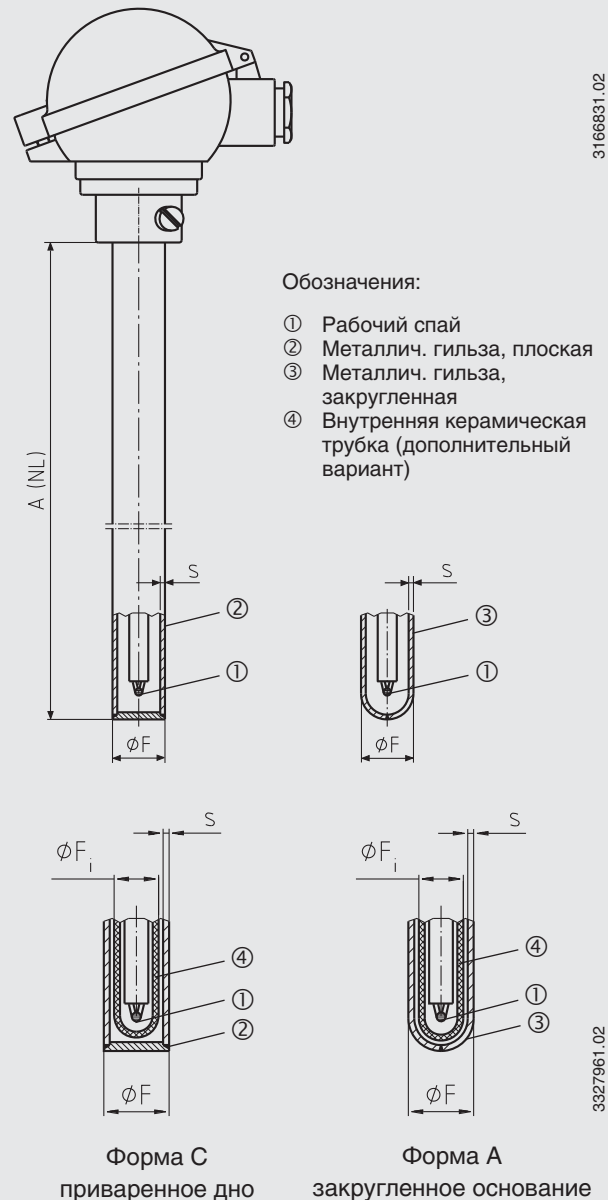
Размеры защитной гильзы и внутренней трубки, мм
