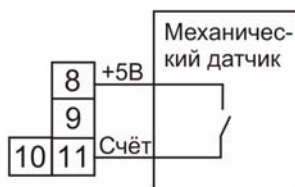
Рис. 2.4. Подключение датчиков TTL - типа
