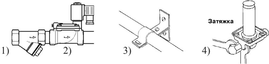
1) Перед монтажом клапана трубопроводы должны быть прочищены, так как попадание в клапан инородных частиц может привести к выходу его из строя. Перед входным отверстием соленоидного клапана необходимо установить фильтр-грязевик.
